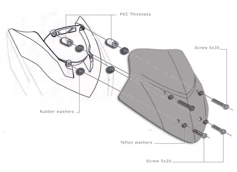
REMOVE THE ORIGINAL WINDSHIELD/SCREEN. FIX THE BARRACUDA WINDSHIELD/SCREEN USING THE SPECIFIC SCREWS LIKE THE DESCRIPTION.
